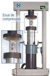
En cours de chantier il pourra être prélevé des éprouvettes de béton, à la sortie de la bétonnière ou du dispositif døapprovisionnement Ces éprouvettes seront transmises à un laboratoire agréé, chargé de vérifier :
